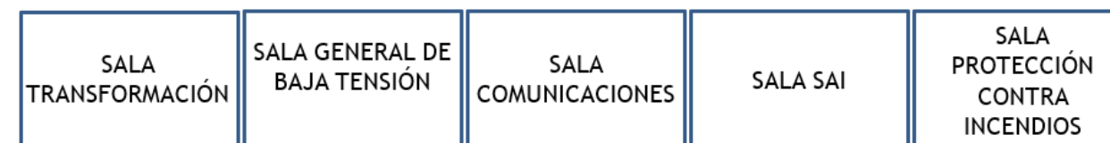
Figura 10: Estructura y composición general de un CT.
